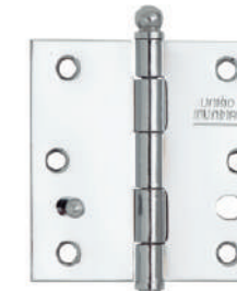
Dobradiça 3" x 3" Pino Bola com Pino de Segurança 292 - Aço 392 - Latão Opção Canto Redondo
